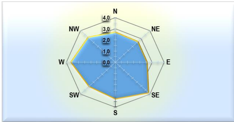
Фигура № 1.3.5. Средна годишна скорост (m/s) на вятъра по посока, ст. Велико Търново
