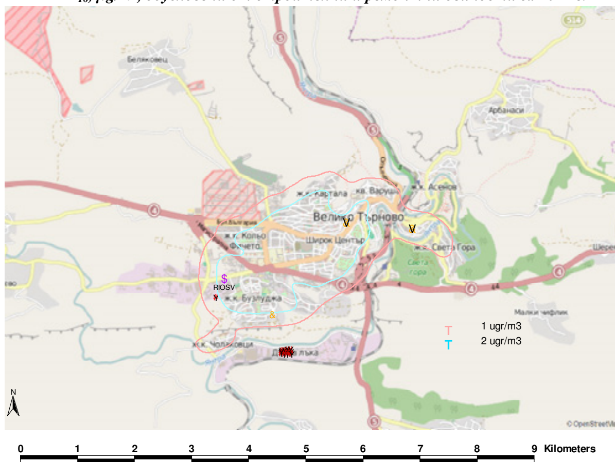
Фиг.6.1.15. Разпределение на средногодишните стойности на концентрацията на \text{ФПЧ}_{10} , \mu\text{g}/\text{m}^3 , обусловени от строителни и ремонтни дейности за 2014 г.
