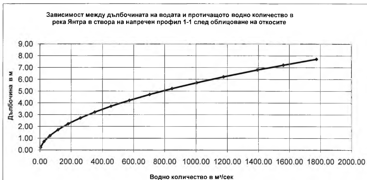
Фиг. 9. Зависимостта между водните стоежи и протичащото водно количество след облицоване на откосите и изграждане на допълнителна дига от 1,0 м.
