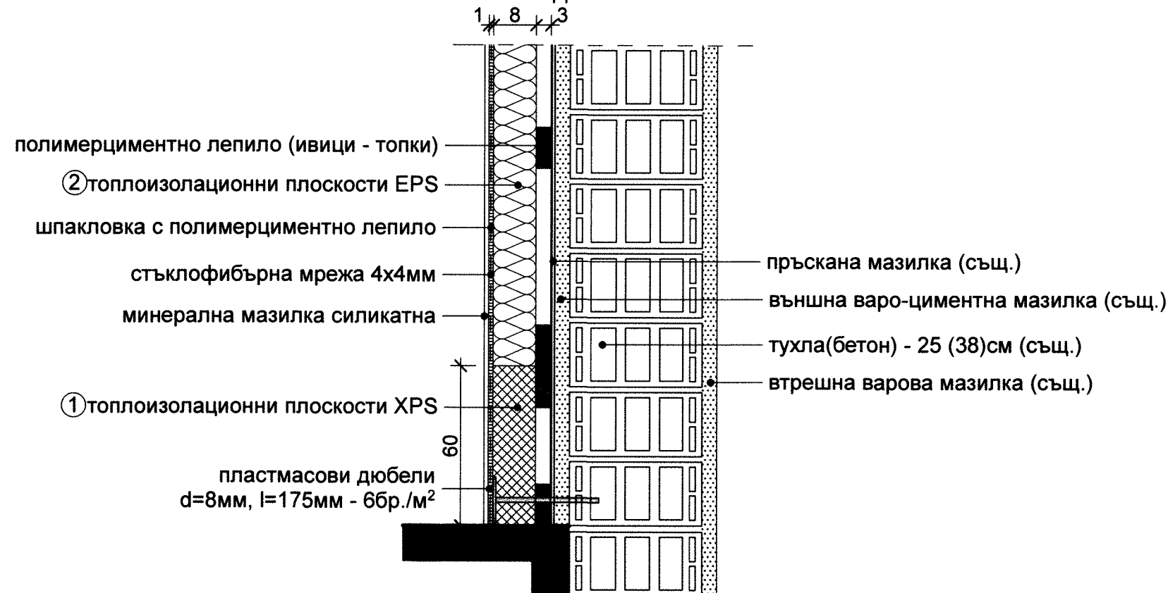
ДЕТАЙЛ "Д" ЗА ТОПЛОИЗОЛАЦИЯ НА ЦОКЪЛ И СУТЕРЕН - ПО ВСИЧКИ ФАСАДИ
